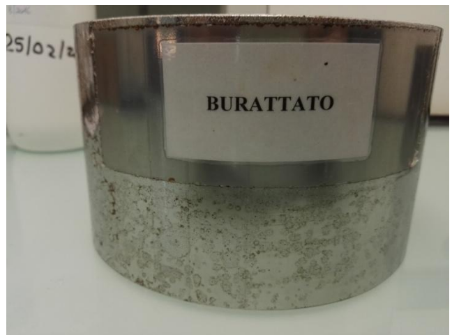
Fig. 4: Tubo burattato dopo lavaggio
