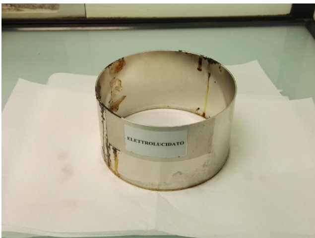
Fig. 3: Tubo elettrolucidato dopo due giorni
